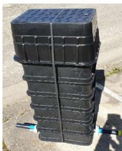
Le regard compteur est enterré et installé dans la propriété de l'abonné à environ 1 mètre de la limite de propriété. On y installe le compteur d'eau et seul le couvercle reste apparent à la fin des travaux. Cette implantation facilite les opérations de relève des compteurs par la collectivité et permet d'éviter les dégâts des eaux dans les caves des usagers suite à des fuites syndicales accidentelles.
