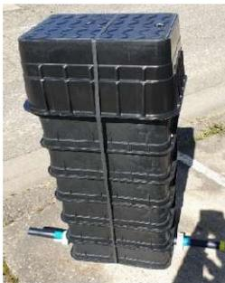
Le regard compteur est enterré et installé dans la propriété de l'abonné à environ 1 mètre de la limite de propriété. On y installe le compteur d'eau et seul le couvercle reste apparent à la fin des travaux. Cette implantation facilite les opérations de relève des compteurs par la collectivité et permet d'éviter les dégâts des eaux dans les caves des usagers suite à des fuites syndicales accidentelles.
